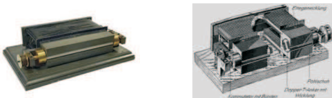
Abb. 8.9. Lks.: Der erste nach dem dynamoelektrischen Prinzip arbeitende Generator von WERNER SIEMENS, wofür er geadelt wurde, steht heute im Deutschen Museum © Siemens. Re.: Prinzipskizze dieses Generators.
