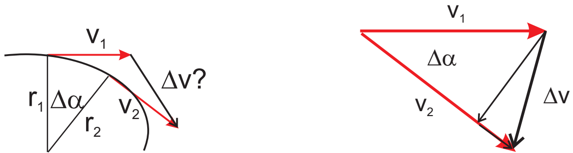
Abb. 1.8. Bei einer gekrümmten Trajektorie (lks.) kann man den Differenzvektor nicht einfach durch gewohnte Vektorsubtraktion ermitteln. Wie aus der rechten Graphik ersichtlich, kann man die Änderung der Geschwindigkeit in einen parallelen und einen dazu senkrechten (orthogonalen) Anteil zerlegen.
